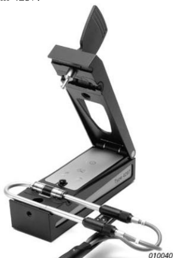
Фиг. 2г Калибриране на проба за звуков интензитет – използвайки патентования от Brüel & Kjær калибратор за звуков интензитет, тип 4297
