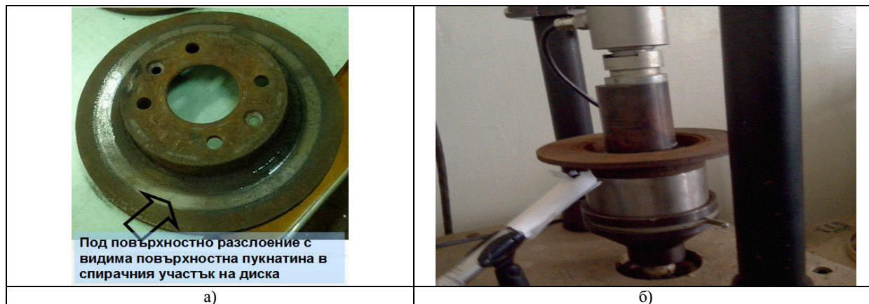
Фиг. 2. Изображение на диск с доказани разслоения и видими повърхностни пукнатини (а) и момент на изпитване на фиксиран диск (б)
