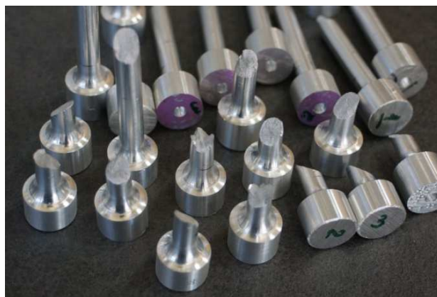
Фиг. 2. Образци след изпитване на опън.
